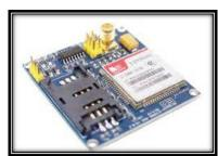
Figure 5. GSM module
